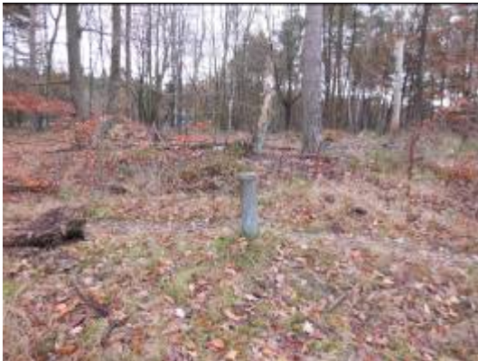
Foto B1.8 Peilbuis boven op het talud ten oosten van de locatie
